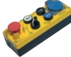
MS-LV5 YUKARI (1NO) ORTAK (1NO) AŞAĞI (1NO) 0-1 REVİZYON (1NO) ACİL STOP BUTON (1NC) 16A KAPAKLI PRİZ EL TERMİNALİ
